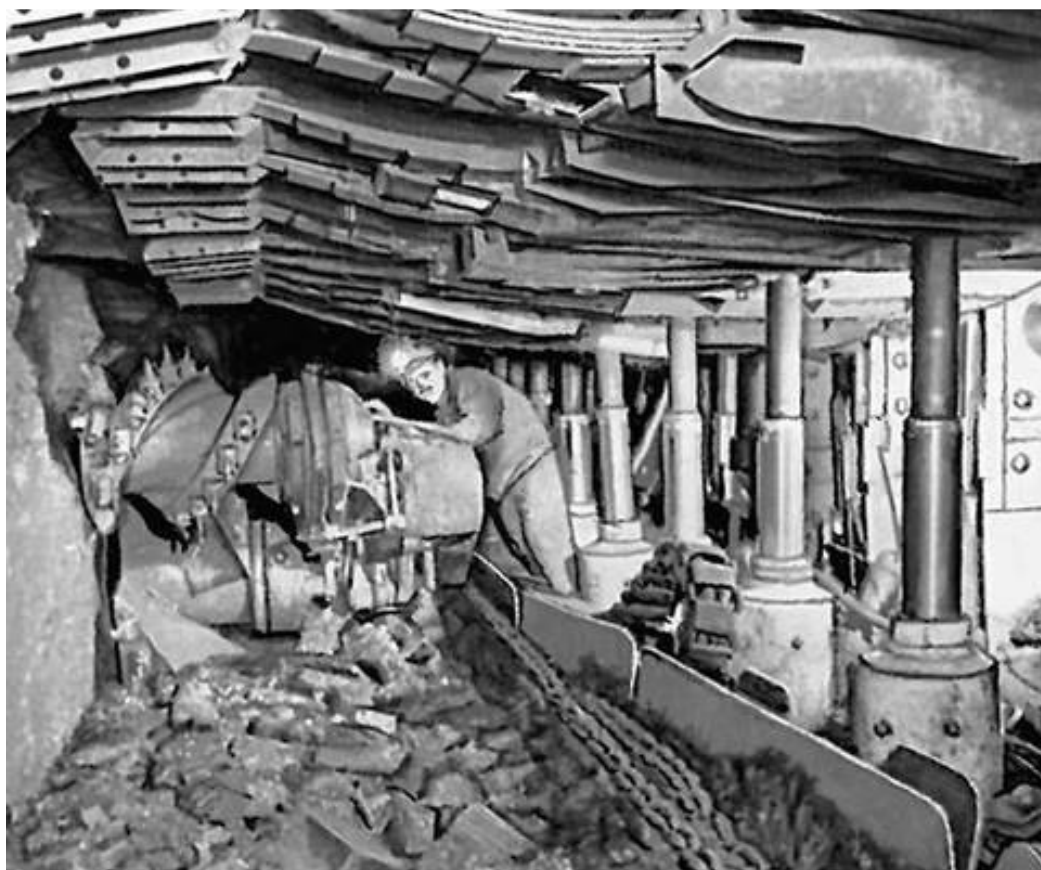
Выемка пластов при помощи очистных комплексов. Комплекс КМ-87ДН в угольном забое (источник: URL: http://www.photogallerys.ru/encrusonline/31655.html#.WmNRmq5l-Uk (дата обращения 20.01.2018 г.))
